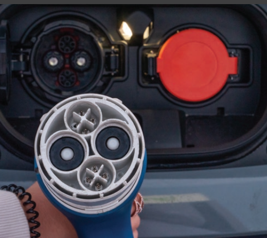
■ Konektor CHAdeMO. Používa sa na DC nabíjanie na Japonských vozidlách Nissan a Mitsubishi a na niektorých starších modeloch iných značiek.
