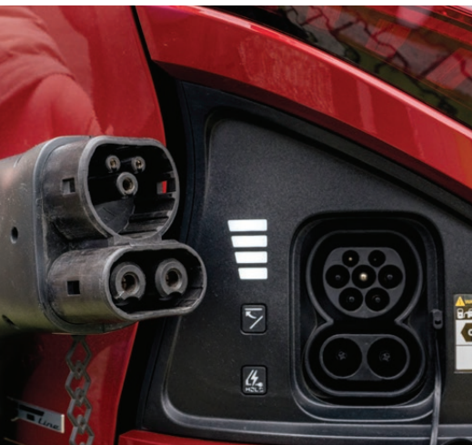
■ Európsky konektor štandardu CCS Combo. Používa sa na DC nabíjanie
