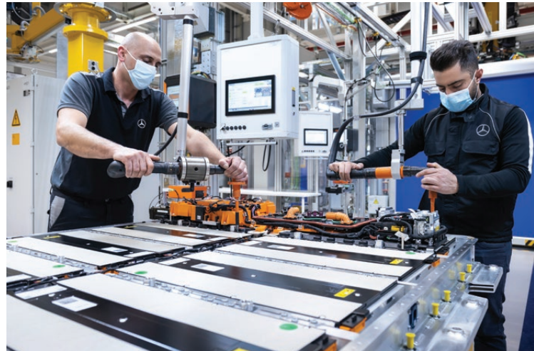
■ Kompletizácia batérií vyžaduje množstvo precíznych operácií vykonávaných manuálne.
